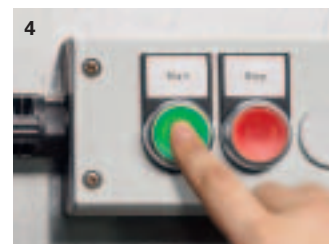
4 Zapnout. Motor běží s regulovanými otáčkami.
